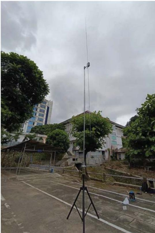
Gambar 4. Antena dipol portabel dalam kondisi terpasang.
