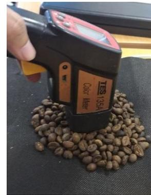
Gambar 9. Pengujian Warna Biji Kopi Hasil Penyangraian dengan Colormeter
