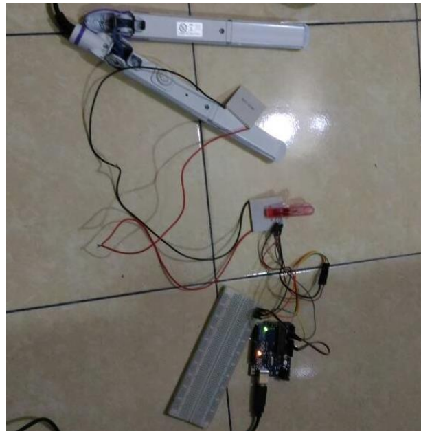
Gambar 4. Pengukuran nilai tegangan peltier generator dengan sumber panas heater
