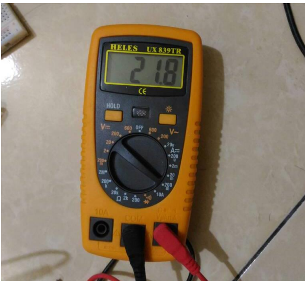
Gambar 3. Pengujian kalibrasi multimeter terhadap tegangan yang diukur
